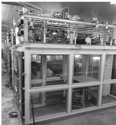
写真1 呼吸試験チャンバー 成牛1頭が滞在できる大きさ。
